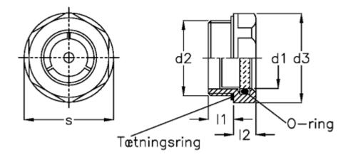
d1 = 18 d2 = M26x1,5 d3 = 32 l1 = 9.0 l2 = 8.0 Max pressure = -Max vacuum mbar = s = 30
